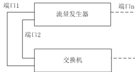
图 7 整机吞吐量测试图
